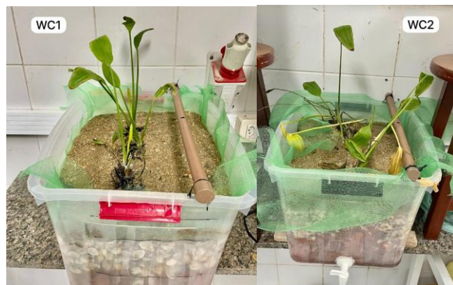
Figura 08: Visualização das macrófitas Echinodurus subalutus vegetando os wetlands construídos (WC1: com camada de concha inteira; WC2: com camada de concha triturada) em escala de bancada na segunda semana do período de adaptação.
