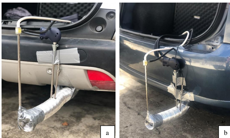
Figura 2: Veículos 1 (a) e 2 (b) com o tubo prolongador e sensores acoplado ao sistema de escapamento.
