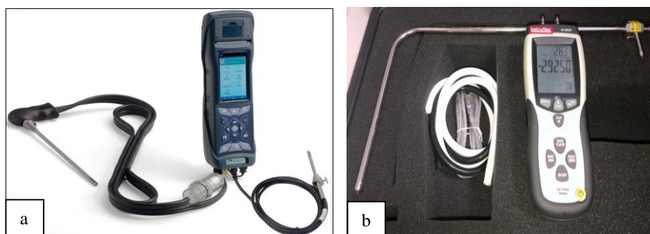
Figura 1: Equipamentos embarcados: analisador de gases portátil (a) e medidor de fluxo de gases de escapamento (b).
