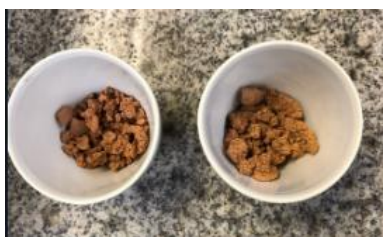
Figura 8. Corpo de prova que se rompeu após a queima
