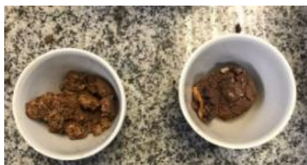
Figura 9. Corpo de prova que se rompeu após a queima.
