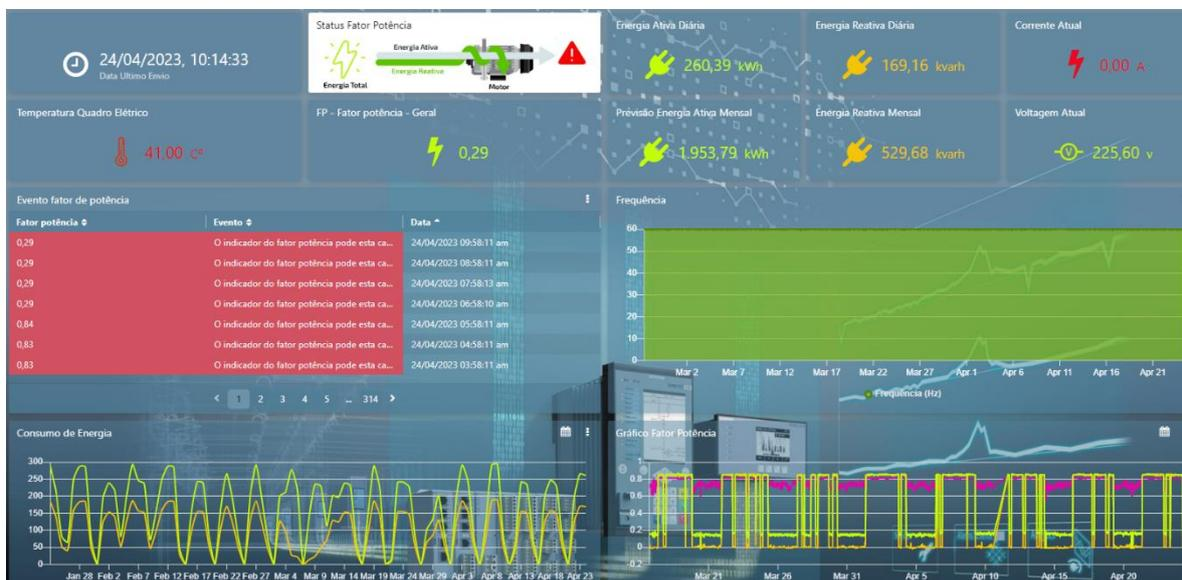
Figura 14 – Dashboard dos dados de energia do motor/bomba. Fonte: Autores do artigo.
