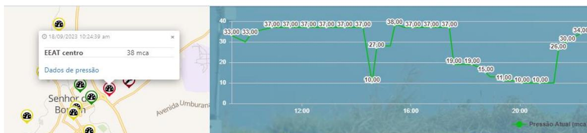
Figura 8 – Dashboard na plataforma de nuvem exibindo os dados de pressão, qualidade de sinal e geolocalização do ponto de pressão na cidade de Senhor do Bonfim. Fonte: Autores do artigo.
