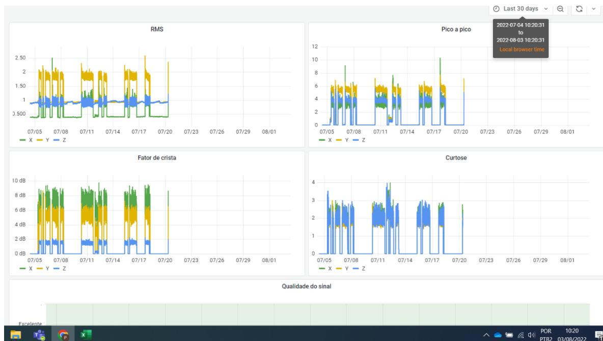
Figura 13 – Dashboard dos dados de vibração do motor/bomba. Fonte: Autores do artigo.
