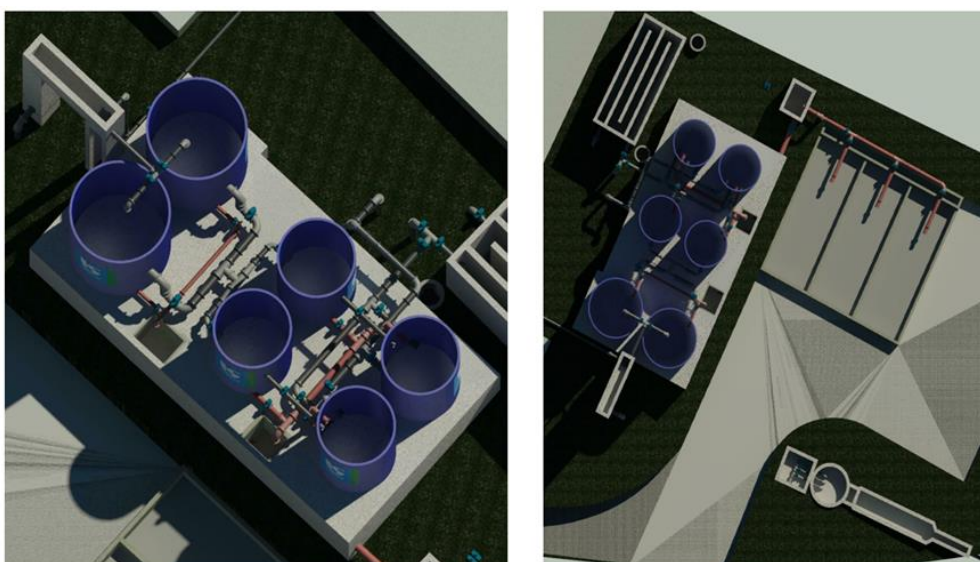
Figura 4: Vista do projeto da ETA compacta e leito de secagem 3D.
