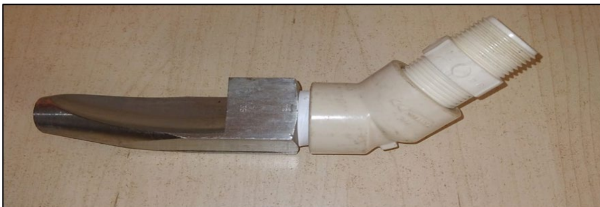
Figura 3: Aspersor modificado sem prolongamento (Aspersores 3 e 4).
