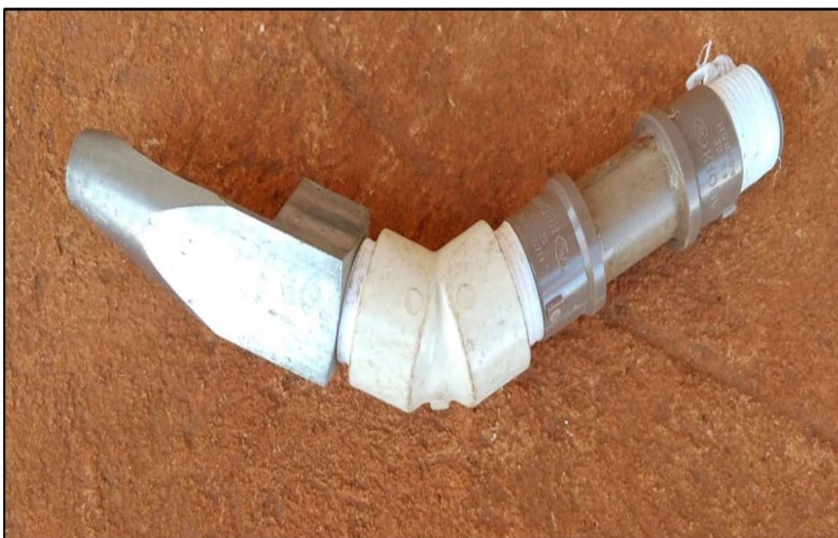
Figura 4: Aspersor modificado com prolongamento (Aspersores 1, 2 e 5).
