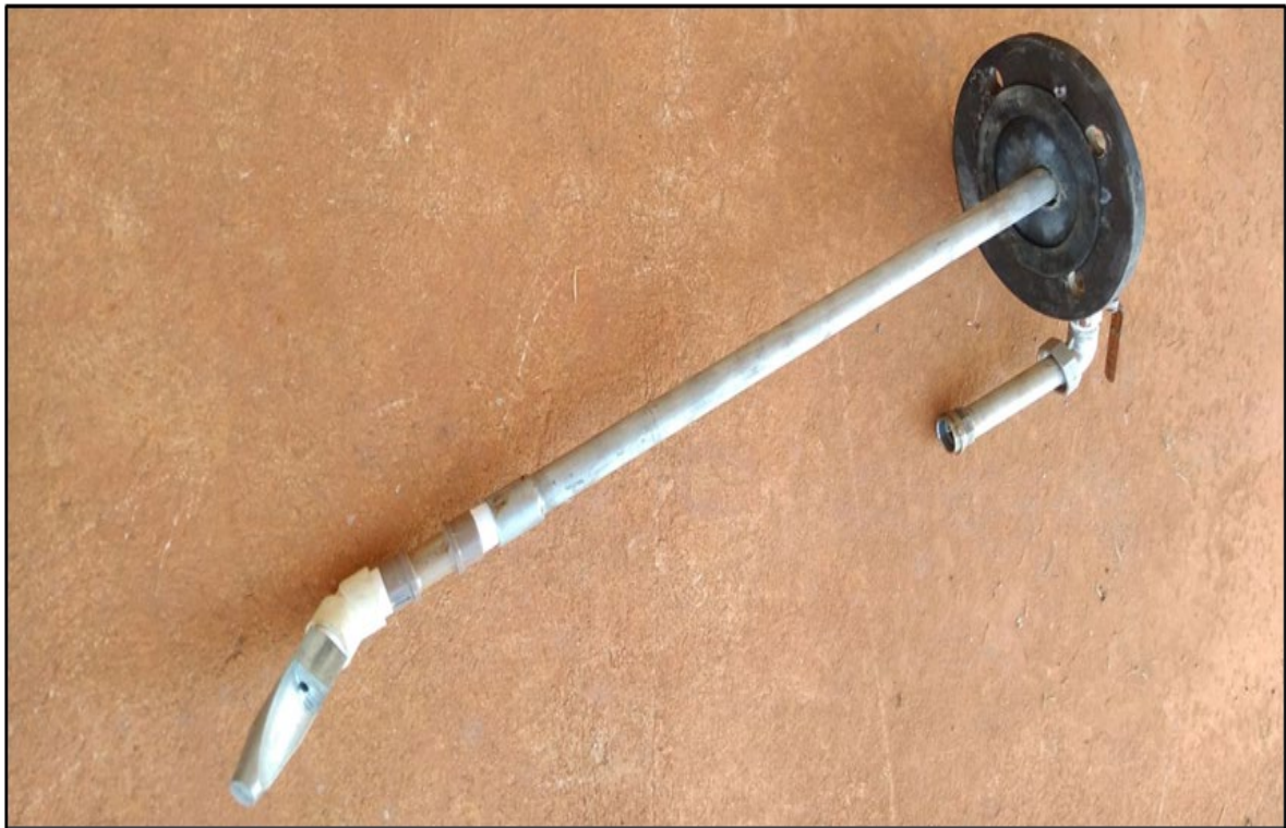
Figura 5: Sistema de aspersão após a modificação.
