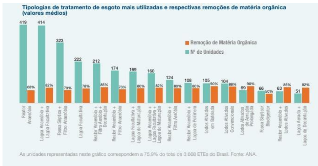
Figura 4 – Tipologias de Tratamento de Esgoto mais Utilizadas e Respectivas Remoções de Matéria Orgânicas (Valores Médios). Fonte: ANA, 2022.
