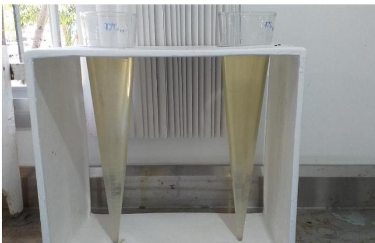
Figura 9: amostras após adição de MgO nos cones *Imhoff*. Fonte: autoria própria.
