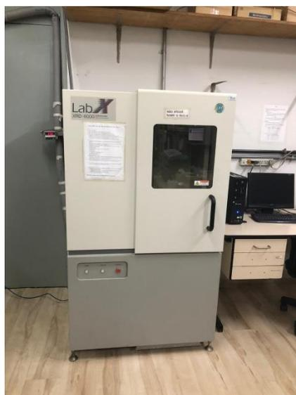
**Figura 22 - Difratorômetro modelo XRD-6000.**
