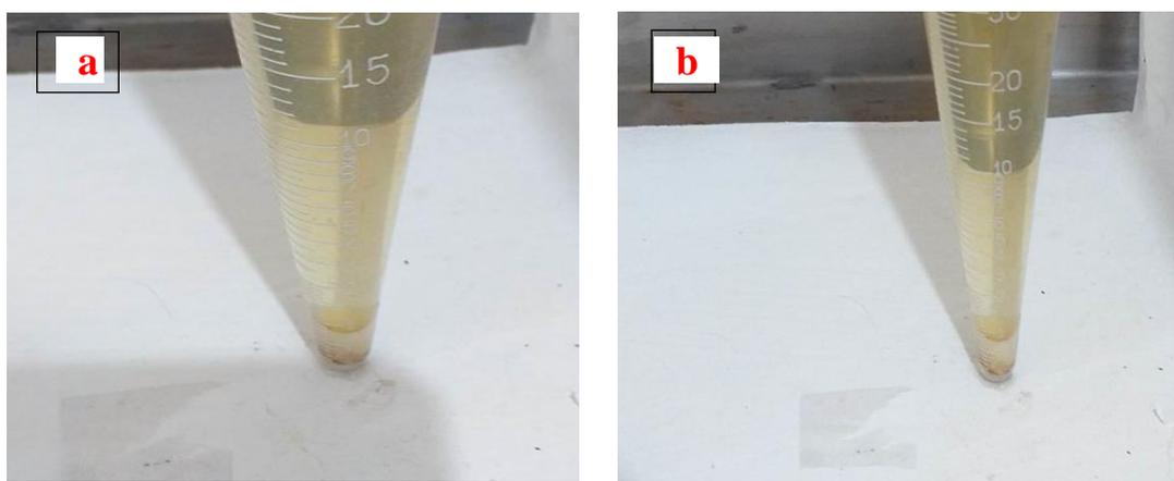
Figura 10 - Sedimentos obtidos no cone *Imhoff* (a), (b)
