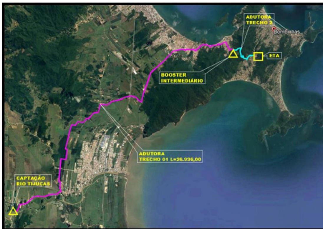
Figura 1: Localização da adutora de água bruta analisada no município de Bombinhas (SC)
