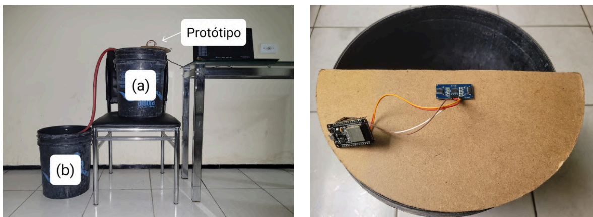
Figura 2: Modelo reduzido para simulação de transferência de água entre reservatórios.
