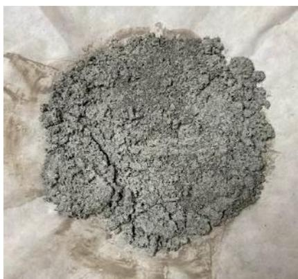
Figura 4 – Amostra de lodo retirada do tanque de resfriamento após secagem.
