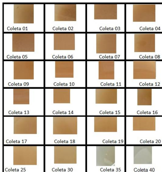
Figura 10 – Coleta da água de Lavagem do Filtro Ascendente de Brazabrantes – 04 de nov. de 2021.
