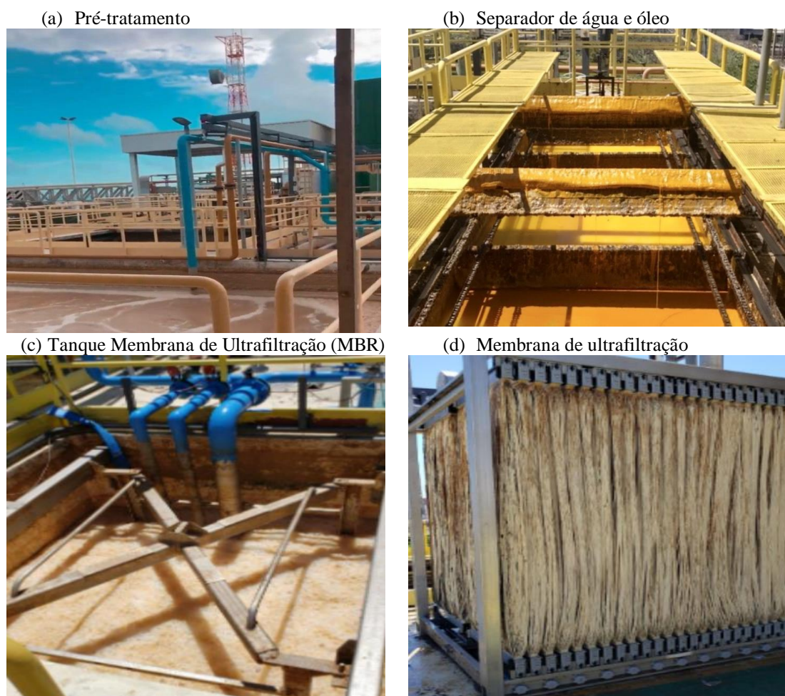
Figura 02 – Fotografias de algumas etapas do processo de tratamento do efluente
