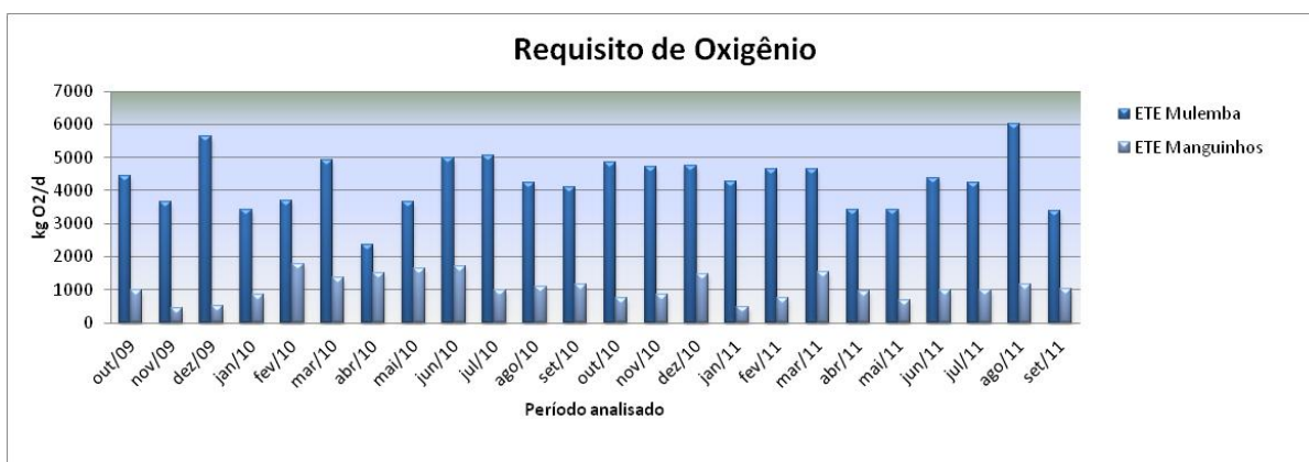
Figura 7: Comparação entre os requisitos de oxigênio calculados das ETEs Manguinhos e Mulemba, para atender às demandas carbonáceas e de nitrificação no período de 2009 a 2011.
