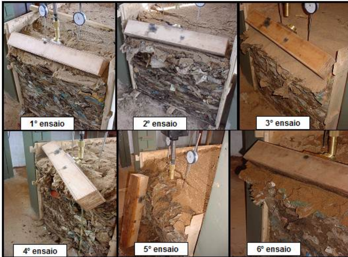
Figura 4: Ruptura dos 6(seis) taludes de lixo ensaiados.
