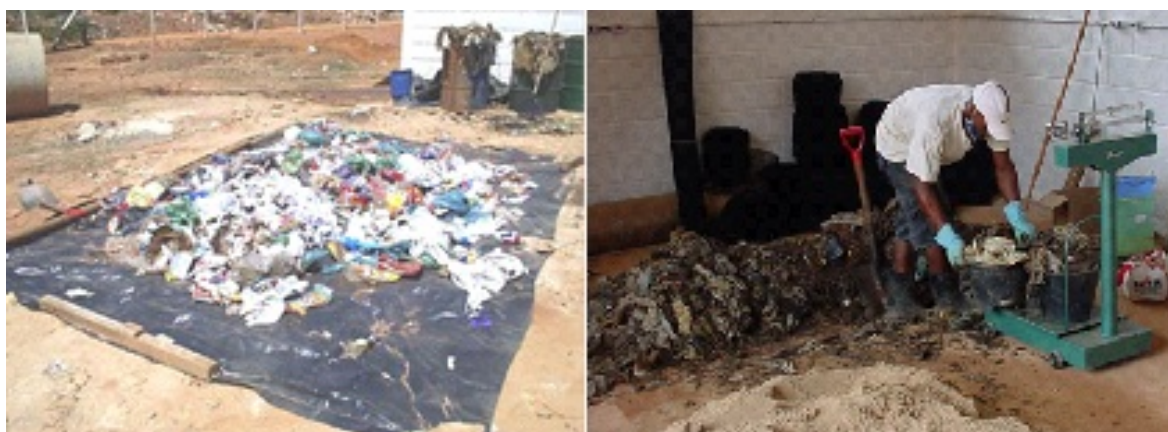
Figura 1: Quartejamento e determinação da composição gravimétrica dos RSU.
