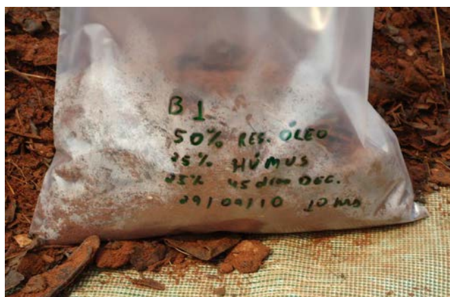
Figura 2: Amostra de resíduos para compostagem preparada com (50% de resíduos de óleo mineral e terra) + (50 % de resíduos putrescíveis e húmus).
