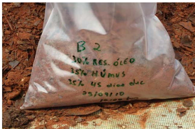
Figura 3: Amostra de resíduos para compostagem preparada com (30 % de resíduos de óleo mineral e terra) + (70% de resíduos putrescíveis e húmus).
