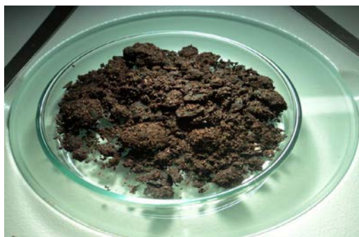
Figura 7: Material formado por húmus, resíduos orgânicos putrescíveis semi compostados e terra contaminada com óleo mineral isolante e óleo vegetal.
