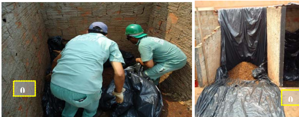
Figuras: 5 e 6: Revolvimento do material que estava sendo compostado em uma das baias disponíveis para o experimento.
