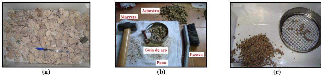
**Figura 3 – a) Amostra de ARC. b) Equipamentos utilizados para moagem manual das amostras classificadas . c) Amostra passante pela peneira com abertura de 9,5 mm.**
