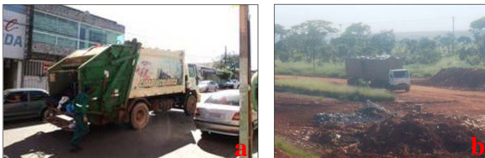
Figura 4: Caminhões utilizados na coleta convencional de Cidade Ocidental e Valparaíso de Goiás: (a) Caminhão Compactador; (b) Caminhão com Carreta Articulada.
