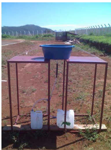
Figura 2: Sistema de coleta de água de chuva
