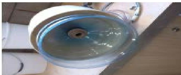
Fotografia 02: Dispositivo para o direcionamento do gás para a saída.
