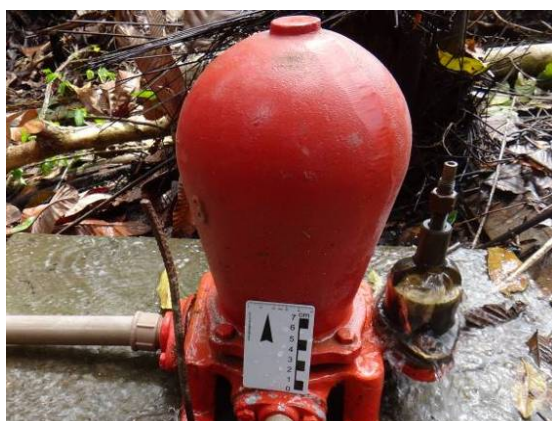
Figura 5: Carneiro hidráulico da aldeia Areia
