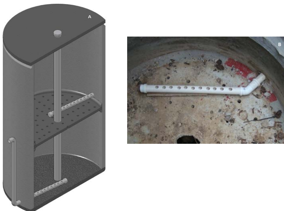
Figura 1 – Esquema do filtro anaeróbio (A) e detalhe da placa perfurada e tubulação de coleta (B)
