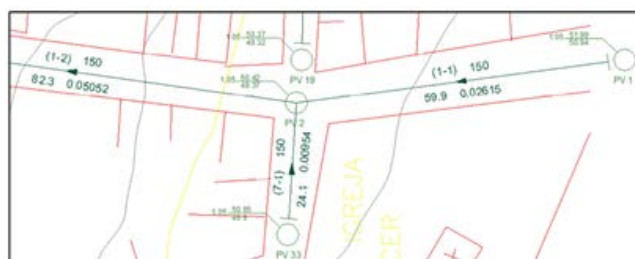
Figura 7 – Parte de rede coletora traçada com o UFC9.
