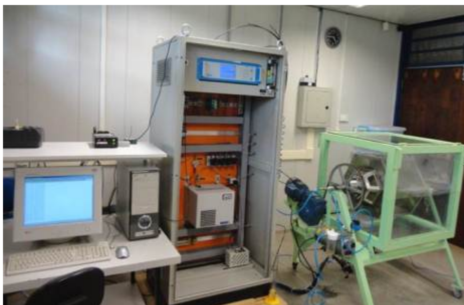
Figura 3: Estrutura do processo de experimentos de compostagem formada basicamente por: tambor rotativo, analisador de gases e microcomputador para aquisição de dados.
