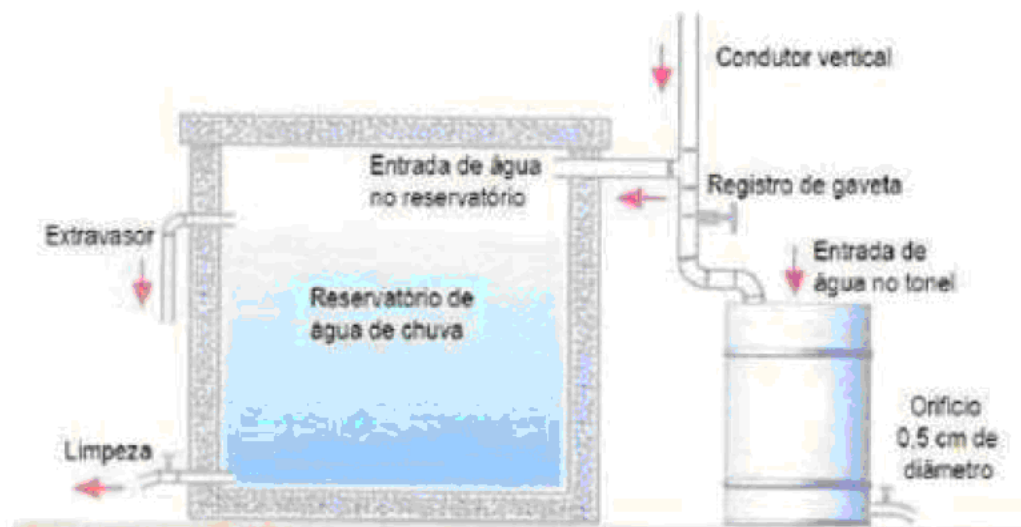
Figura 3: Esquema parcial de sistema de aproveitamento de água da chuva.
