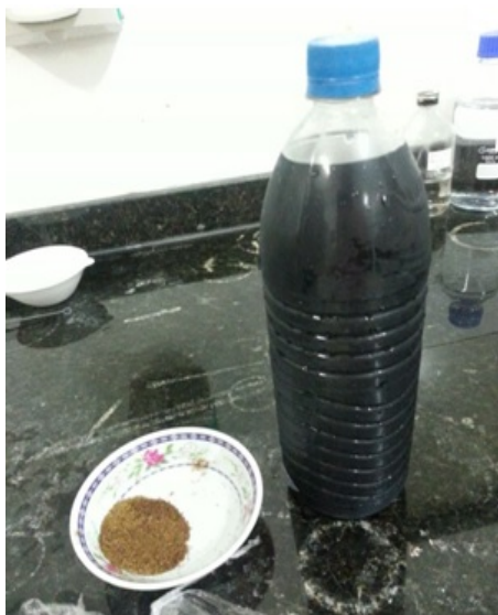
Figura 3: Pó da casca da banana e amostra da água residual contida no tanque de armazenamento.
