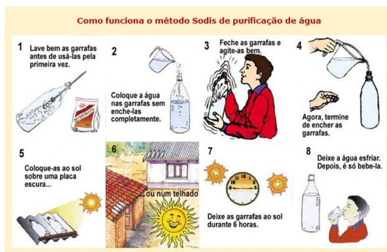
Figura 3: Etapas da técnica SODIS. (SODIS, 2011)
