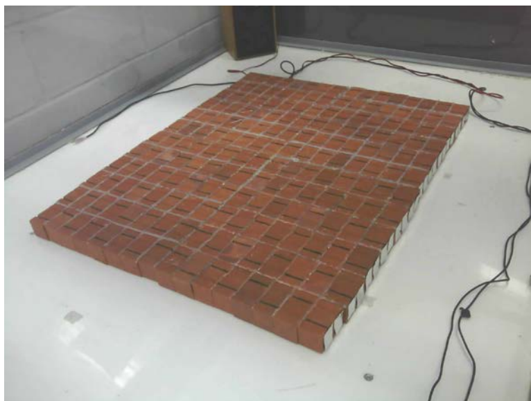
Figura 1: Painel de blocos cerâmicos acústicos com a vedação das laterais prontos para obtenção dos tempos de reverberação
