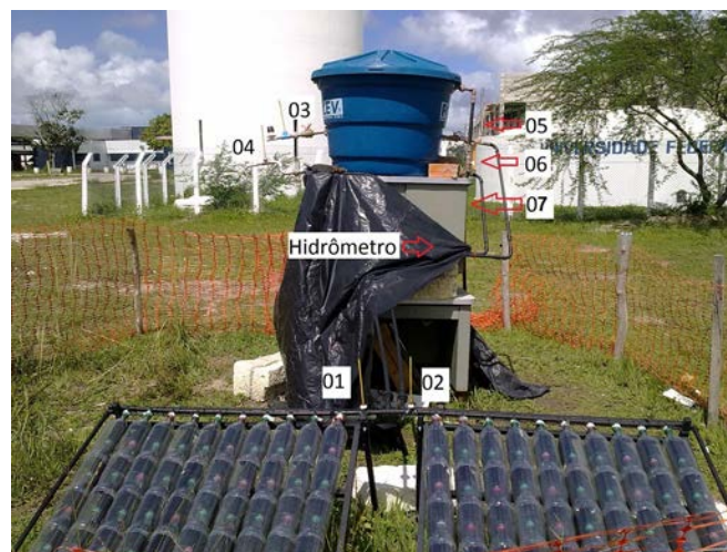
Figura 1 – Aquecedor solar de baixo custo com indicação da localização dos sete termômetros e o hidrômetro.
