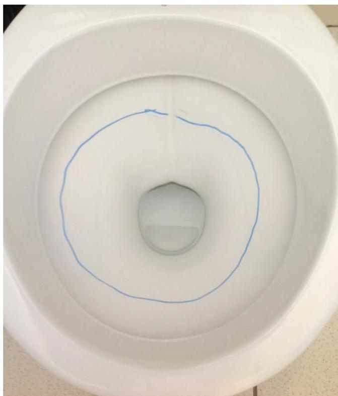
**Figura 1: Filete de água cortando a linha de marcação da bacia sanitária.**
