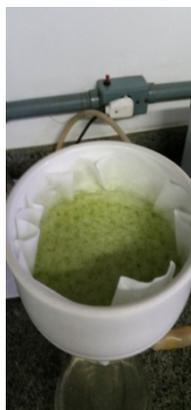
**Figura 2 - Pré-Filtragem de Amostra para ensaio de DBO**
