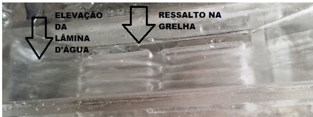
Figura 5 – Ressonância na Grelha e Elevação da Lâmina D'Água na Depressão da Boca de Lobo Simples
