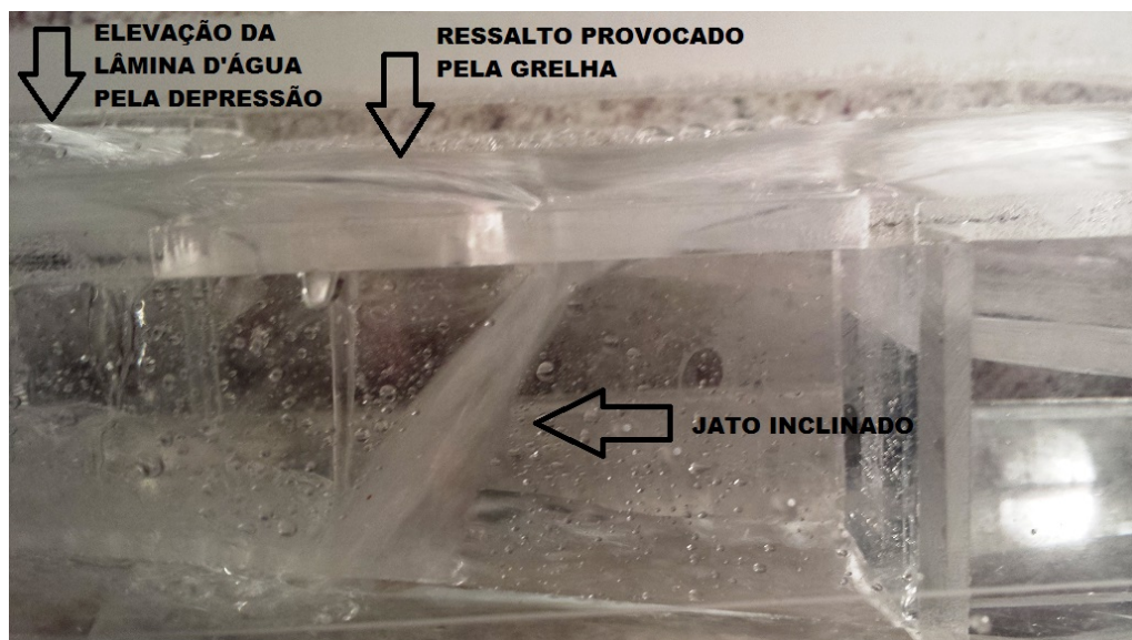
Figura 6 – Visualização do Ressonância na Grelha da Boca de Lobo e Jato Direcionado pelo Impacto do Fluxo na Grelha
