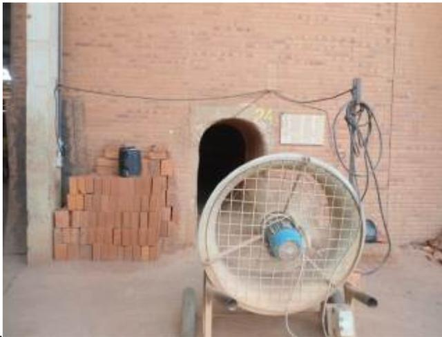
**Figura 21: Ventiladores para resfriamento do forno.**
