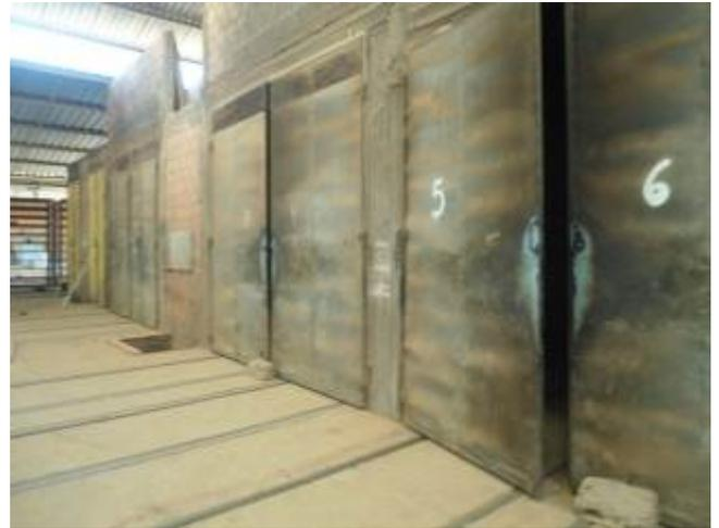
Figura 18: Saída das vagonetes do secador. Fonte: autor, 2014.
