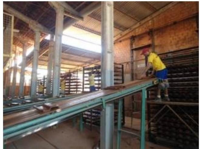
**Figura 16: Telhas após prensagem nas vagonetes. Fonte: autor, 2014.**
