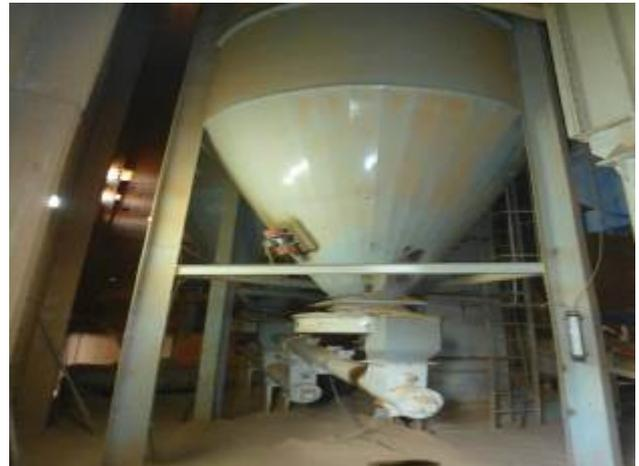
**Figura 8: Silos com capacidade de 80 toneladas. Fonte: autor, 2014.**
