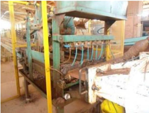
**Figura 13: Desmoldante e Cortador. Fonte: autor, 2014.**
