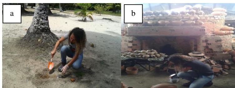
Figura 3: Coleta de solo superficial (a) e medição da concentração de Pb em solo superficial (b).
