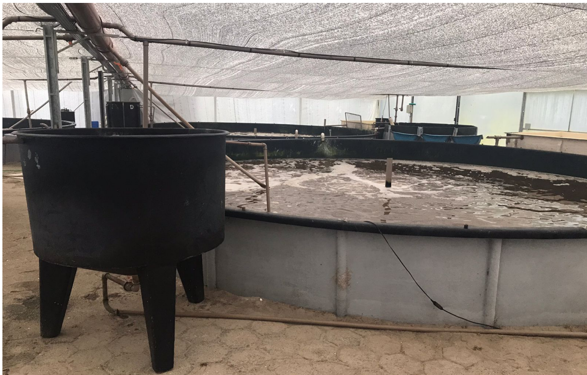
Figura 2. Sedimentador para remoção de SST e tanque para cultivo de camarões.
