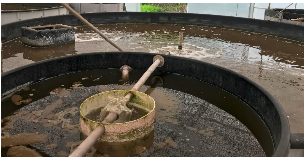
Figura 3. Sedimentador (esquerda inferior) utilizado para as coletas de lodo proveniente dos tanques de cultivo de camarões em sistema BFT.
