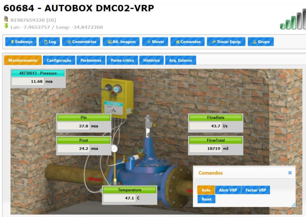
Figura 9 - Sistema Vectorasys: VRP de um dos DMCs de Olinda com seu quadro de comandos por telemetria
