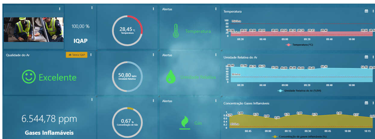
Figura 9. Ambiente de análises dos dados dos sensores de gás da prototipação.
