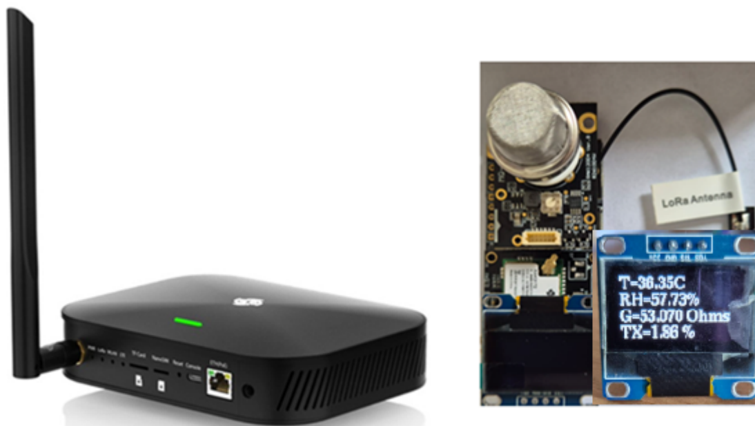
Figura 4: Gateway e chip IoT LoRa, visor, placa base, visor com as taxas e concentração de gás, temperatura, umidade e sensor de gás para os testes realizados.
