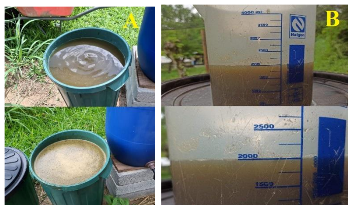
Figura 4 – (A) Água residuária da bovinocultura antes e após o período de 48 horas e homogeneização. (B) Volume de 2000 mL de água residuária aplicado em cada wetland construído.
