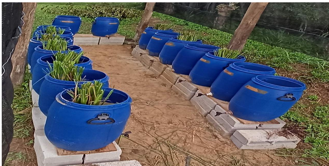
Figura 2 – Estrutura experimental das wetlands em escala piloto.
