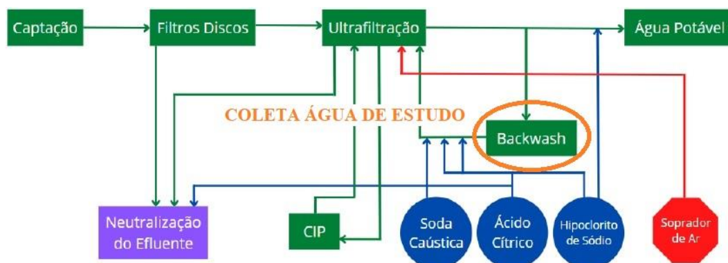
Figura 2: Fluxograma de operação da ETA Lago Norte com o ponto de coleta de água de estudo (Fonte: Modificado – Abreu, 2022).
