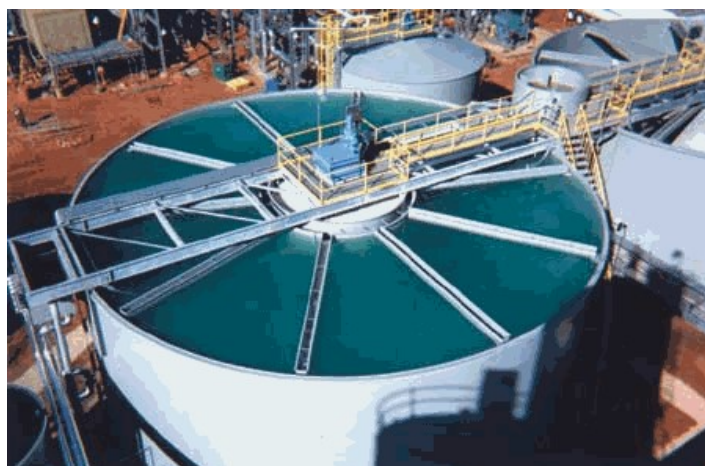
Figura 3 – Modelo de Floco-Decantador com recirculação
