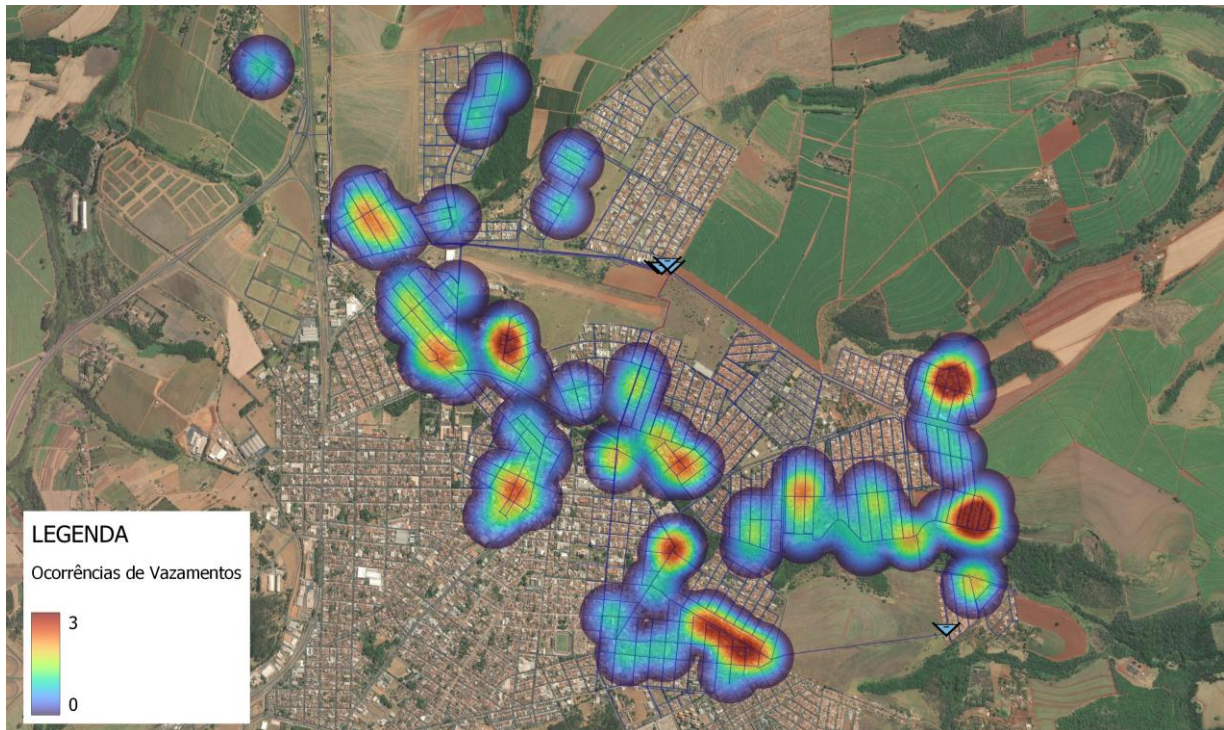
Figura 3: Densidade da ocorrência de vazamentos identificados entre 2023 e 2024
