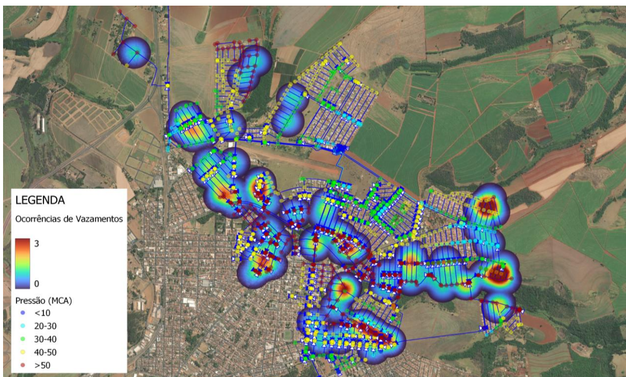
Figura 4: Cruzamento entre dados de ocorrências de vazamentos e pressões do sistema na hora de menor consumo
