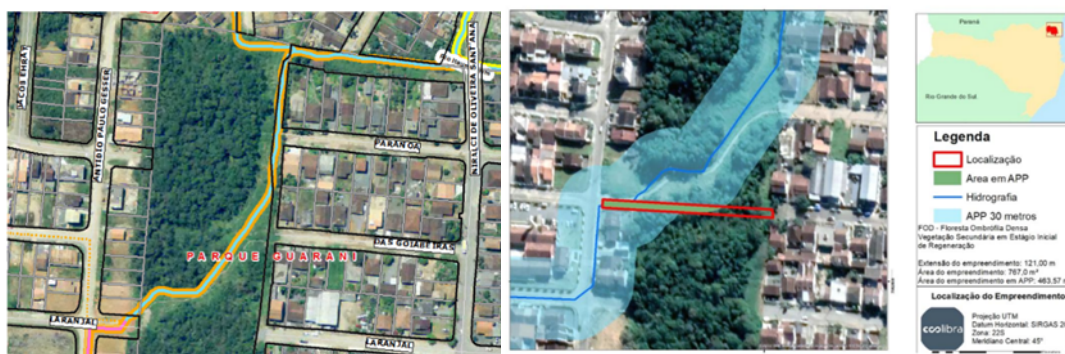
Figura 4 - Traçado previsto (esquerda) e traçado alternativo com MND (direita) após análise preliminar para uma travessia
