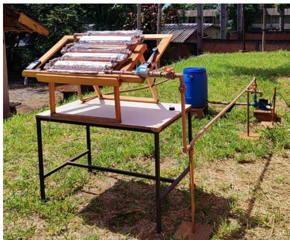
Figura 1 - Imagem do sistema de tratamento de lixiviado com o reator CPC
