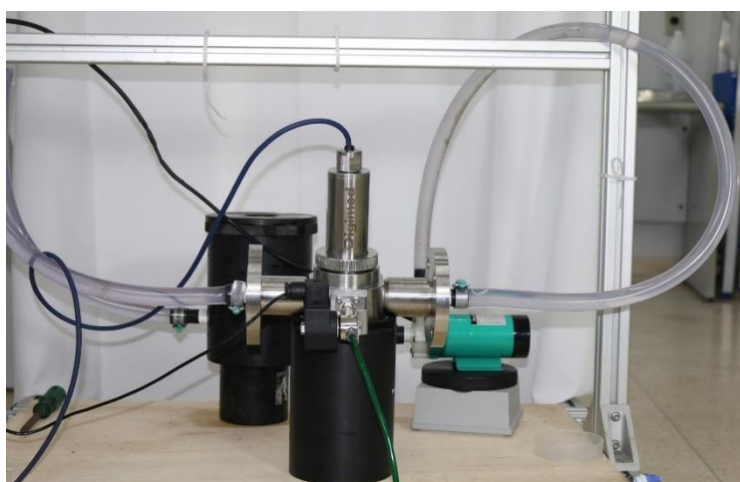
Figura 3 – Sistema em fluxo e sonda de medição para SAC 254 .
