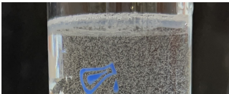
Figura 6: Formação de bolhas visíveis após ensaio inicial realizado na UHP-F.
