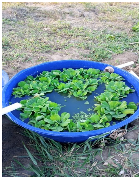
Figura 1: Tanque de macrófitas utilizado para polimento dos efluentes dos wetlands construídos de plantas emergentes.
