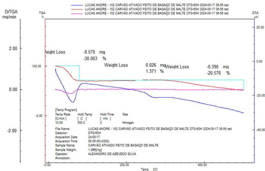
Figura 2: Resultado da análise termogravimétrica.
