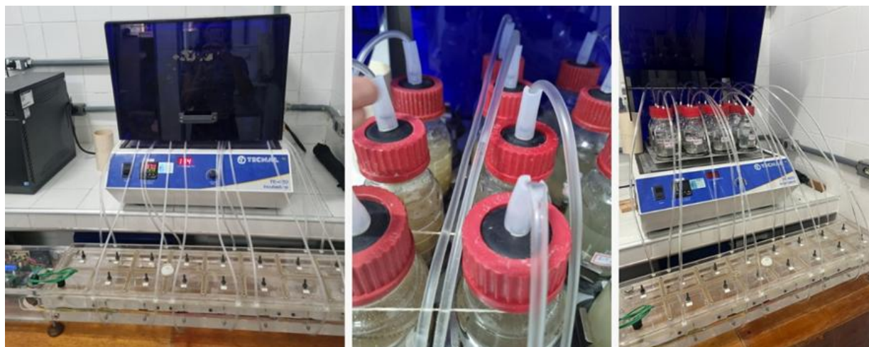
Figura 4: Reatores dispostos em incubadora e conectados ao quantificador de biogás.
