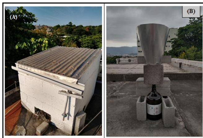
Figura 1: Estruturas utilizadas para coleta das amostras das águas de chuva. Em (A) a estrutura com o telhado em aço galvanizado e em (B) o funil para captação direta da água da chuva.
