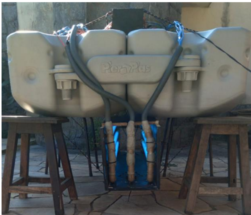
Figura 3: Reator de radiação ultravioleta em funcionamento fora d'água.
